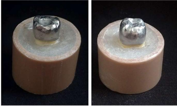
**Figura 4.** Inclusão das amostras em cilindro pvc, sem ligamento periodontal
