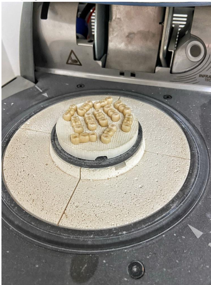
Figura 6. sinterização (Programat EP 5000-G2, Ivoclar vivadent, Schaan, Liechtenstein) a 750 ° C.
